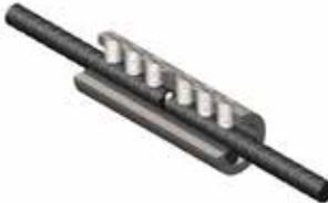
Après le montage, les deux barres doivent rester alignées avec le coupleur. Le désalignement ne peut excéder 5 mm sur une longueur de 25 cm.
