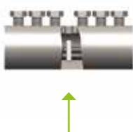
Serrer les boulons jusqu'à ce que les têtes des boulons se rompent. Le serrage se fait également du centre vers l'extérieur. Après le montage, les deux barres doivent rester alignées avec le coupleur. Le désalignement ne peut excéder 5 mm sur une longueur de 25 cm.
