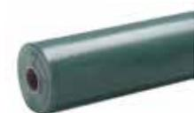
Film de construction en polyéthylène utilisé comme protection ou en tant qu'élément pare-humidité au niveau du plancher. Il est fabriqué par extrusion et est non-stabilisé aux UV.
