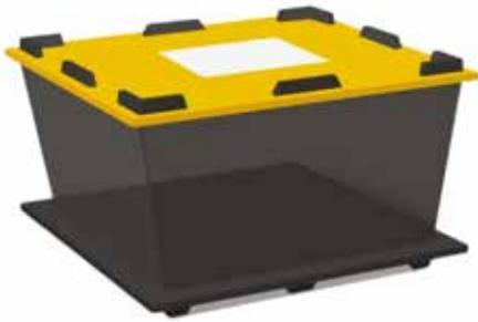
La Rézaboîte est un coffrage de réservation avec système de fond coffrant pour le passage des tuyaux/gaines en dalle béton. Son fond coffrant ancré latéralement dans le béton facilite le rebouchage de la réservation sans avoir à coffrer.
