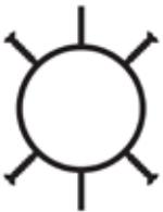
Joint de dilatation créant des points de rupture prédéterminés.
