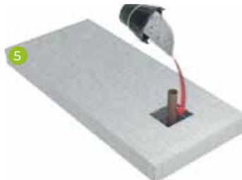
5 Découpe du fond coffrant à l'aide d'une scie cloche/scie sabre au diamètre du futut traversant. Passage de tuyau/gaine à travers le percement réalisé.
