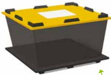
La Rézaboîte CV est un coffrage de réservation avec système de fond coffrant pour le passage des tuyaux/gaines en dalle béton. Son fond coffrant ancré latéralement dans le béton facilite le rebouchage de la réservation sans avoir à coffrer.
