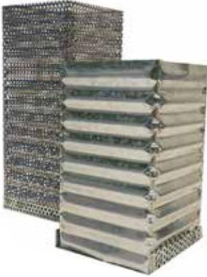
Les boîtes d'ancrage ANKRABOX sont utilisées comme coffrage perdu pour des réservations d'ancrages d'éléments futurs dans le béton armé ou comme coffrage perdu extérieur. Conçues en tôles de métal ondulé, les jonctions entre celles-ci sont réalisées par soudure.
