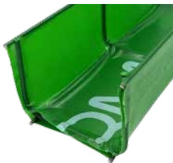
Coffrage perdu composé d'un treillis d'armatures en acier enveloppé dans une membrane en plastique. Il est utilisé comme coffrage pour les ouvrages enterrés tels que les semelles de fondation, les dalles, les têtes de pieux et massifs.
