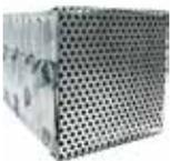
Métal déployé à fines mailles soudé à la boîte d'ancrage, il permet à l'air de s'échapper et évite la dispersion du béton sous la boîte.
