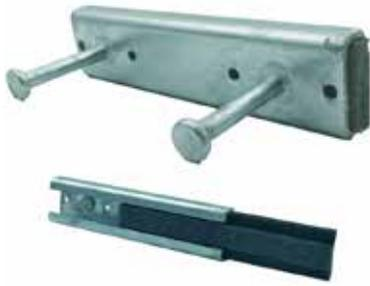
Les rails d'ancrage sont des profilés avec ancres, combinés à des éléments de fixation à tête marteau, utilisés pour réaliser un point de fixation sur un élément préfabriqué. La mousse présente dans le rail empêche la pénétration du béton lors du bétonnage. Celle-ci peut ensuite être enlevée rapidement. Ils sont disponibles en finition brute, en inox A2 ou A4 ou en galvanisée ( \_ = B, A2, A4 ou G ).
