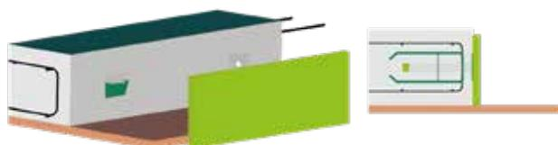
Poser l'armature et couler le béton afin d'achever la première phase.
