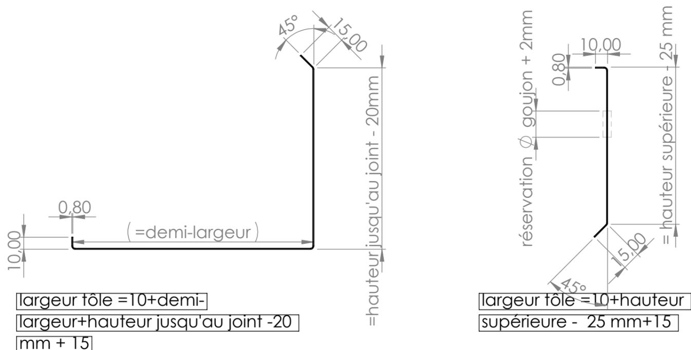
largeur tôle = 10 + demi-largeur + hauteur jusqu'au joint - 20 mm + 15
